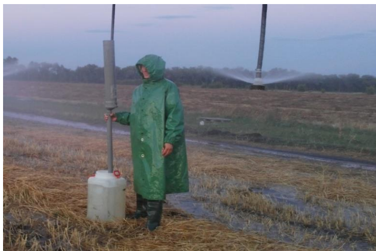
Рисунок 3.2 - Определение расхода воды дефлекторной насадки
