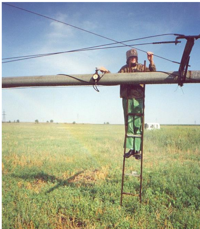
Рисунок 3.3 - Определение напора при помощи трубки Пито
