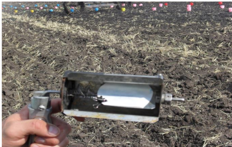
Рисунок 3.4 - Определение крупности капель дождя прибором с бумажным фильтром
