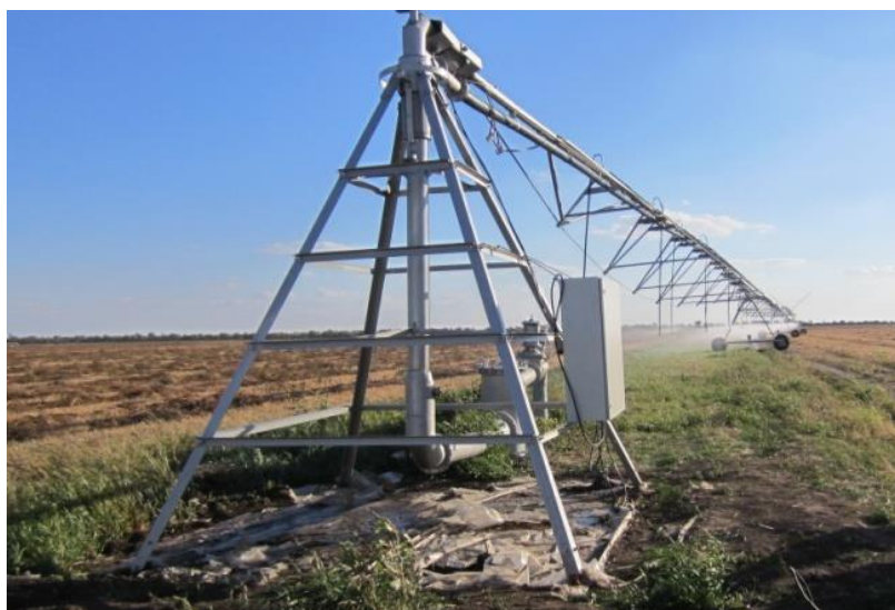
Рисунок 2.1 – Дождевальная машина «Волга-ФК1» в работе на орошаемом участке ОПХ «ВолжНИИГиМ»
