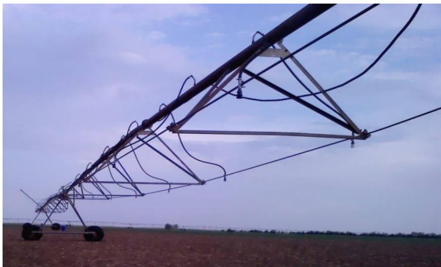
Рисунок 2.6 – Устройство приземного орошения с монтажом дождевальной насадки на шпренгеле ДМ «Кубань-ЛК1» (вариант 1)
