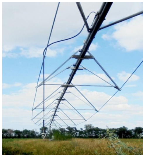
Рисунок 2.6 – Устройство приземного орошения с монтажом дождевальной насадки на шпренгеле ДМ «Кубань-ЛК1» (вариант 1)
