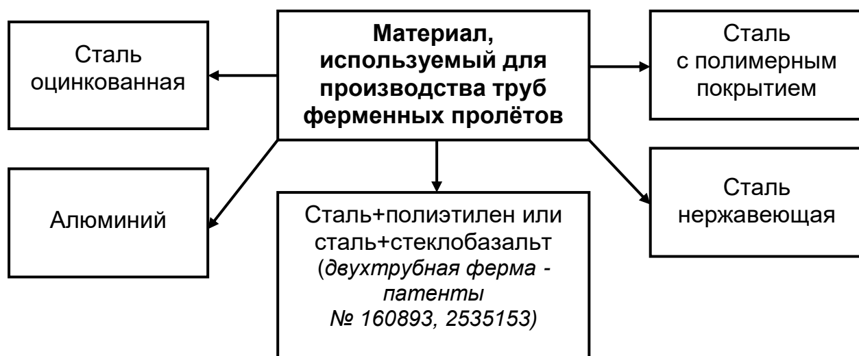
Рисунок 1.4 - Классификация материала труб, используемых для производства ферменных пролётов дождевальных машин
