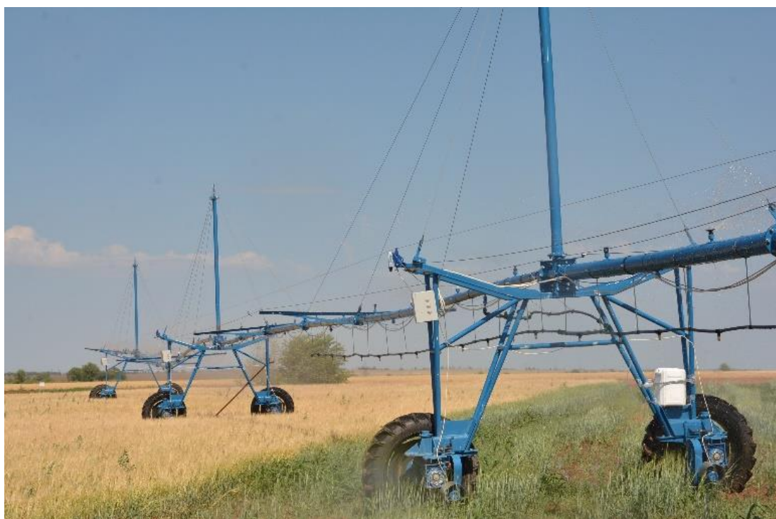
Рисунок 1.5 – Дождевальная машина вантовой конструкции «Дон-К»
